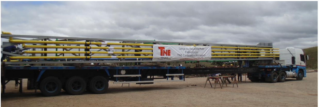
As duas lanças dos queimadores da plataforma P-23, construídas pelo consórcio TNE/EPM, em transporte Fonte: Arquivo João Bezerra Alves
