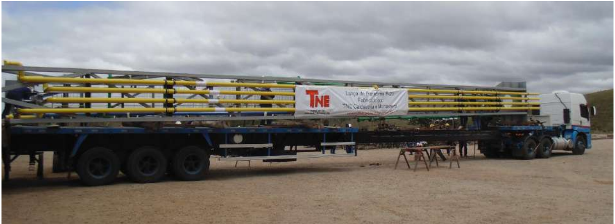
As duas lanças dos queimadores da plataforma P-23, construídas pelo consórcio TNE/EPM, em transporte
